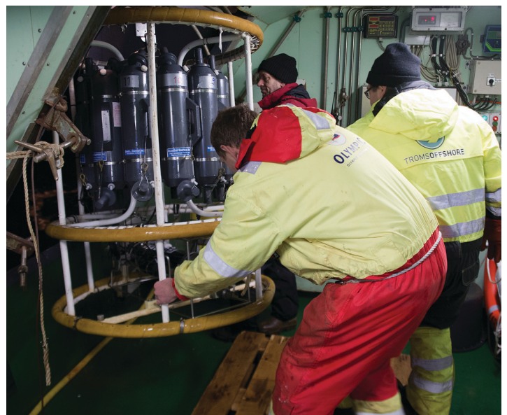
TUNGE LØFT: En såkalt LTD settes ut i havet for å måle hva som er i vannet på forskjellige dybder.
